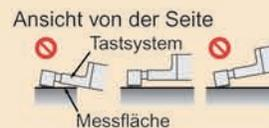
Tastensystem sorgfältig auf dem Werkstück positionieren
