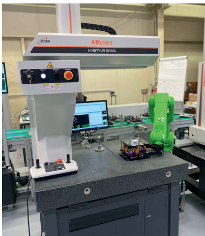
Bild 2. Beladen des KMG MiSTAR555 durch den Roboter FANUC CR14iAL. ©Mitutoyo
