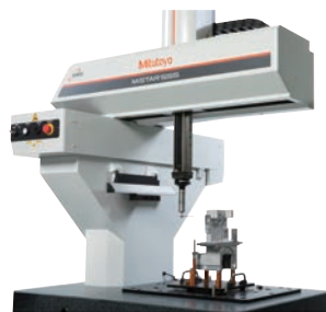
Ausgestattet mit Messkopfaufnahme PH6M
