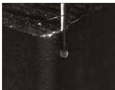
Beeld van een taster vastgelegd met de observatiecamera
