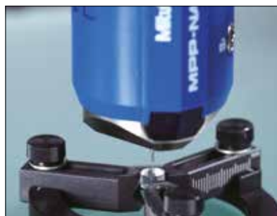
MPP-NANO meting van asferische vorm
